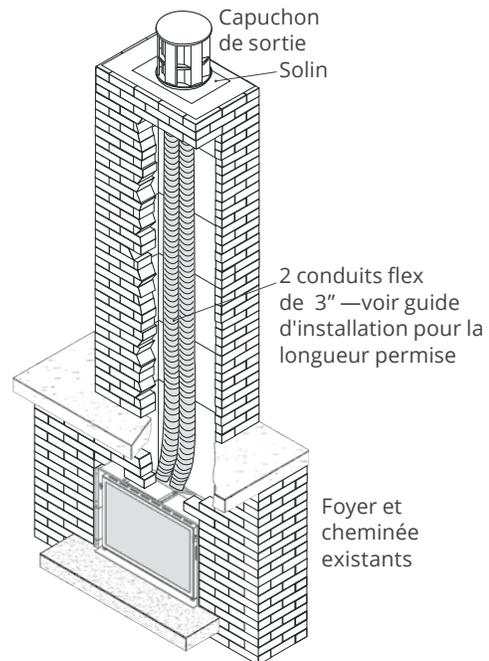
Note : Longueur maximale du conduit d'évacuation G4 : 40' (12.2 m).
