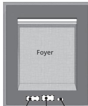
Le récepteur, la soupape et les piles sont situés au bas du foyer derrière le panneau avant ou le panneau amovible
