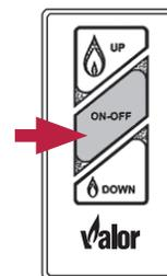
Si les flammes sont allumées, elles diminuent et vous entendez le moteur de la soupape tourner. Puis un claquement et un bip indiquant que la soupape a reçu la commande de la manette.
