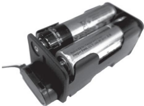
2. De l'espace à gauche du foyer, utilisez le fil déjà branché au récepteur et branchez-le au porte-piles. Placez le porte-piles debout, devant le récepteur.
