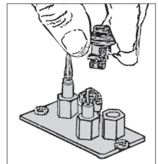
3. Remplacez le avec l'injecteur de veilleuse approprié—voir le tableau *Indices signalétiques* à la page 5. Fixez le nouvel injecteur et serrez-le.
