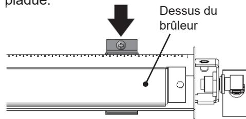
3. Détachez les supports du brûleur en enlevant deux écrous à l'aide d'une clé de 5/16" (8 mm).
