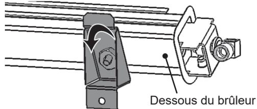
4. Installez les supports de brûleur sur le brûleur de conversion en réutilisant les deux écrous enlevés à l'étape 3. **Note : Ne serrez pas trop les écrous pour éviter de briser les chevilles filetés.**
