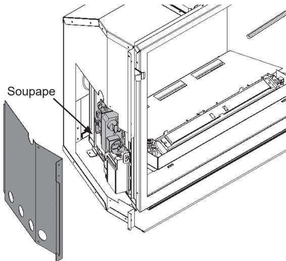
2. Fixez un manomètre à la connexion de vérification de pression d'admission sur la soupape—voir l'image à droite. Ouvrez l'alimentation de gaz.
