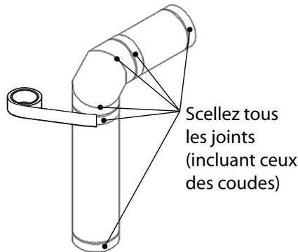
Tout parcours horizontal des conduits doit être élevé de 1/4 po (7 mm) pour chaque portion de 1 pi (30 cm) dans la direction du courant d'évacuation. Pour une sortie d'évacuation au mur, le dernier conduit avant la sortie peut être incliné vers le bas afin de permettre le drainage.
