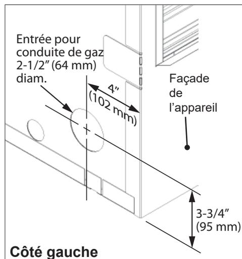
Le diamètre et l'installation de la conduite d'alimentation de gaz doivent être tels qu'ils permettent une alimentation de gaz suffisante pour répondre à la demande maximale de l'appareil sans perte induite de pression.
