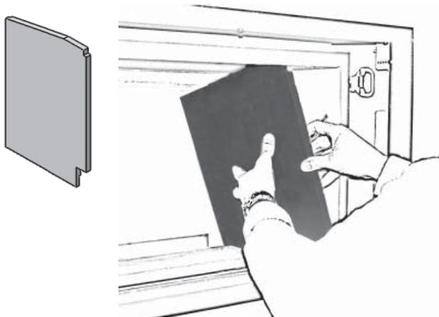
3. Le panneau arrière est fourni en trois sections qui s'imbriquent l'une dans l'autre. Deux des sections sont identiques. Le bord encoché de ces sections se place vers le milieu pour s'imbriquer à la section du centre.
