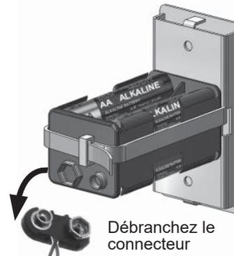
3. Remplacez les piles avec 4 piles **alcaline** AA 1.5 V en les orientant tel qu'indiqué dans le porte-piles.
