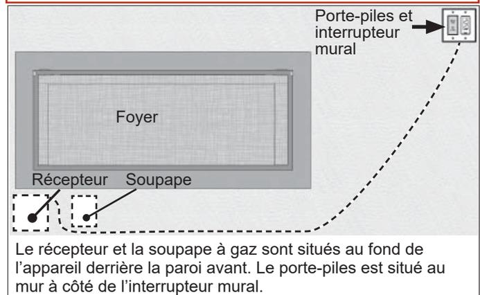
Le récepteur et la soupape à gaz sont situés au fond de l'appareil derrière la paroi avant. Le porte-piles est situé au mur à côté de l'interrupteur mural.
