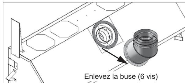
2. Tournez la buse pour que sa sortie soit orientée vers l'arrière et fixez-la de nouveau à l'appareil (6 vis).
