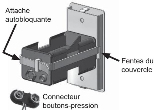
12. Placez le porte-piles contre l'arrière du couvercle et fixez-le avec l'attache autobloquante. Laissez l'espace nécessaire pour attacher le connecteur à boutons-pression du porte-piles.
