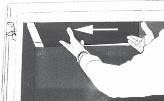
**NOTE :** S'il y a des espaces inégaux entre les sections du panneau arrière, soulevez la languette située à chaque bout du rebord sur lequel sont posées les sections. Pliez légèrement la languette pour fermer l'espace.
