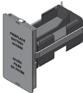
13. Branchez le connecteur à boutons-pression, insérez 4 piles alcalines AA dans le porte-piles (fournies avec le foyer) et insérez le porte-piles à l'intérieur de la boîte de raccordement. Le couvercle du compartiment à piles s'attache à la boîte avec les aimants.
