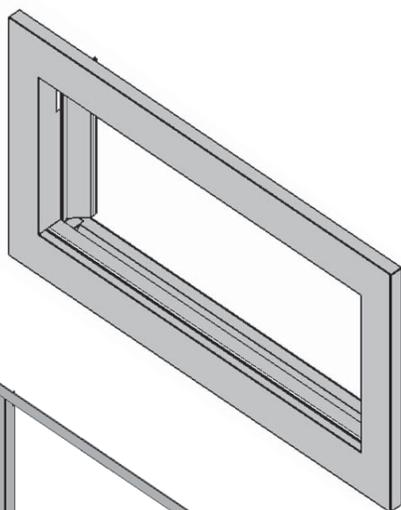
Bordure étroite (1775) peut être ajustée jusqu'à 5/8 po de profondeur à partir de la surface du panneau de béton
