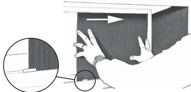
4. Le panneau du haut est fourni en deux sections identiques. Le dessus du panneau est bisauté et le dessous est droit à l'avant et encoché à l'arrière. Lorsqu'installé le panneau repose sur le dessus du panneau arrière et des panneaux des côtés. À l'avant, il est supporté par le support de panneau fixé au rebord avant du foyer.
