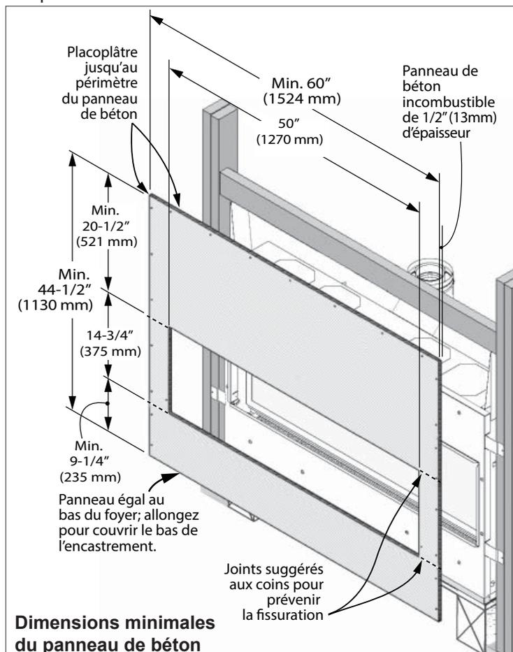
L'extension du panneau de béton en-deça des minimums indiqués aidera à éviter les fissures dues à l'expansion différentes des matériaux.
