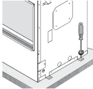
*Assurez-vous que l'appareil est à la hauteur appropriée en considérant la hauteur de la dalle ou du plancher combustible.*
