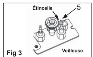
4. **ALLUMAGE MANUEL :** Bouton MAN à MAN (2) (fig. 2). Avec la fenêtre enlevée, repérez la veilleuse (fig. 3) à gauche dans la boîte de foyer.
