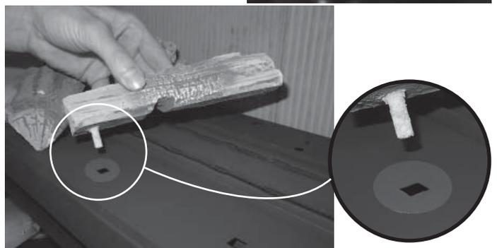
Quelques bûches chevauchent le brûleur; assurez-vous qu'elles reposent au-dessus des petits orifices du brûleur plutôt qu'au-dessus des gros orifices.
