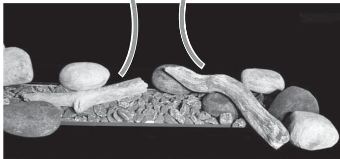
5. Installez les pierres restantes autour du lit de gravier. **Ne placez pas de pierres sur l'écran de la veilleuse!** **Ne placez pas de pierres additionnelles sur le lit de gravier!** Il est possible de varier la position des pierres mais seulement autour du lit de gravier sur la plateforme noire.
