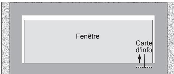
La plaque de directives et d'identification est située derrière le panneau avant en bas de la fenêtre.
