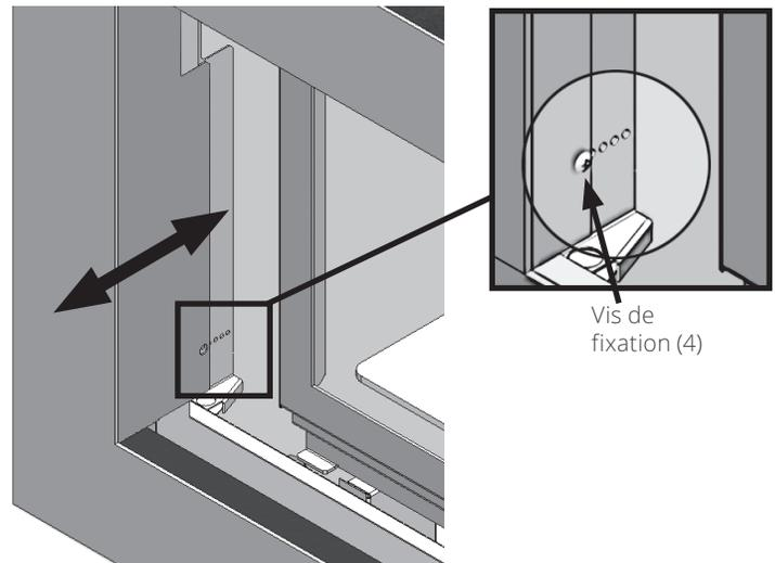
2. Sélectionnez un trou de fixation et fixez la bordure au foyer à l'aide de 4 vis no 8.
