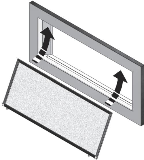
2. Tenez le pare-étincelles par les onglets du bas et insérez les crochets du bas dans les fentes cachées juste derrière la face avant de la bordure.
