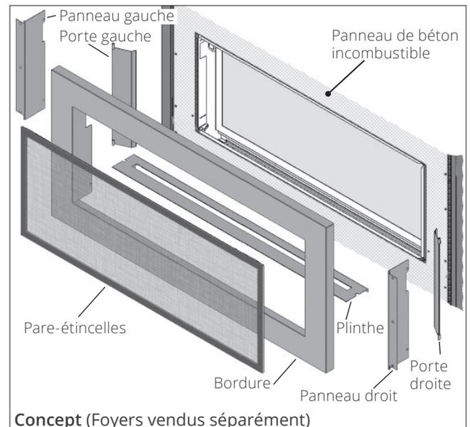
La Bordure Linear 3-1/2" 1550v2 est conçue pour installer sur les foyers Valor Linear L1 1500 et L1 à 2 côtés 1600.
