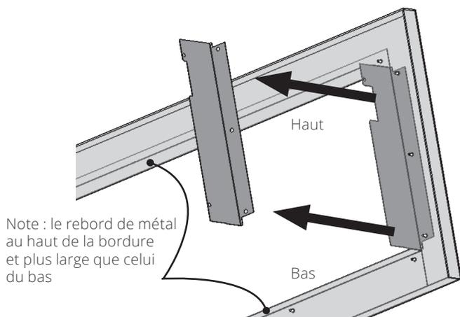
2. Placez les panneaux d'extension sur la bordure tel qu'indiqué et fixez-les avec les 6 écrous (3 de chaque côté).
