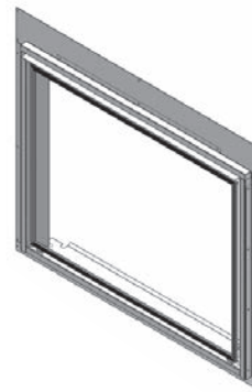
Dimensions minimales du panneau incombustible
