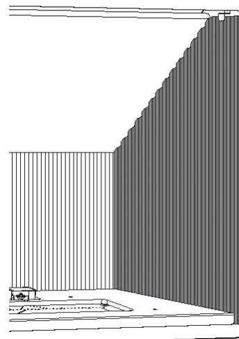
6. Centrez le panneau du haut de façon à ce qu'il repose sur les panneaux des côtés et arrière.
