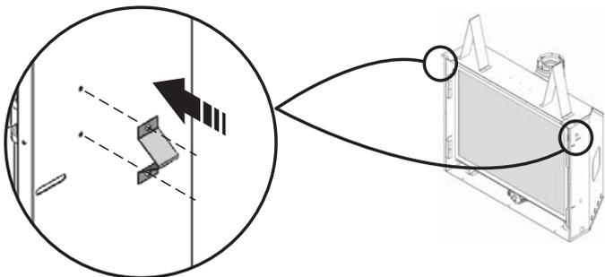
4. Fixez le support du panneau du haut au dessus de la caisse de l'appareil tel qu'indiqué (5 vis).
