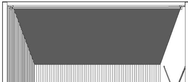
5. Insérez le bas de l'autre panneau de côté entre le brûleur et la paroi de côté, pivotez-le légèrement pour le rentrer dans la boîte de foyer. Poussez-le contre la paroi de côté. Pivotez le support d'ancrage pour tenir le panneau en place.
