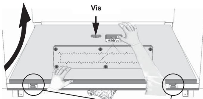
2. Prenez le brûleur tel qu'indiqué et soulevez d'abord le bord arrière et, en le pivotant vers le haut décrochez les pattes avant le retenant à la boîte de foyer. **Faites attention de ne pas endommager le couvercle de la veilleuse en soulevant le brûleur.**
