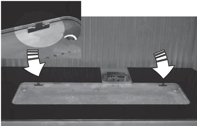
3. Soulevez légèrement la plateforme de verre à son ouverture à l'arrière et insérez le couvercle de veilleuse; les deux pattes seront sous la plaque de verre. Notez l'orientation du couvercle : le rebord doit être situé à l'avant.
