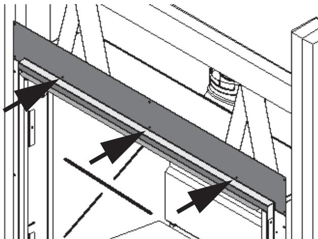
9. Insérez l'appareil dans la charpente et fixez-le aux poutres de chaque côté (6 points de fixation par côté).
