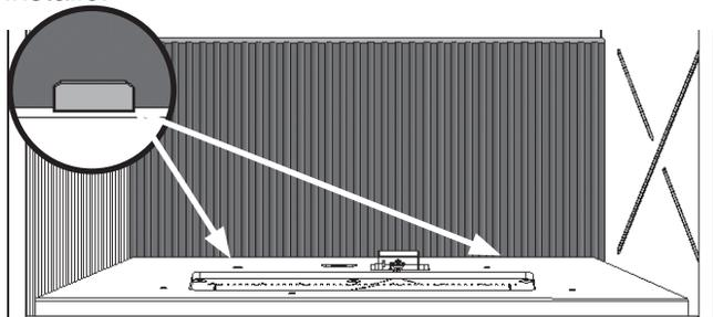
**Note :** Si vous installez le Panneau de verre facultatif 1405RGL (avec les Panneaux cannelés 1425FBL ou les Panneaux noirs 1460PBL), placez le panneau de verre, côté lisse devant, devant le panneau de céramique, retenu par les mêmes onglets de retenue sur la rainure.
