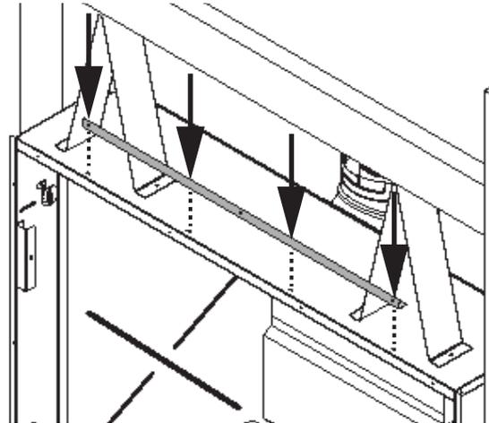
5. Au bas de l'appareil, installez le panneau du bas fourni avec le kit tel qu'indiqué (3 écrous).
