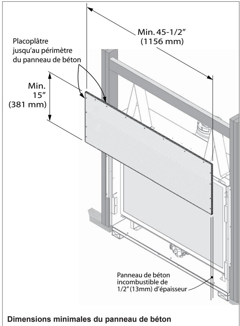
**Dimensions minimales du panneau de béton**
