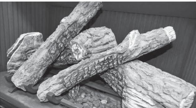
8. Insérez la bûche avant droite sous la bûche droite du dessus en reposant son encoche entre les première et seconde chevilles du porte-bûches en partant de la droite. L'autre bout de la bûche repose sur le lit de gravier. Poussez la bûche vers la gauche jusqu'à ce qu'elle soit contre la dent gauche.
