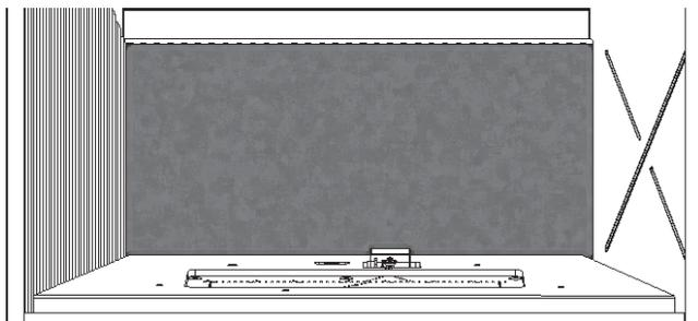
4. Insérez le panneau du haut, côté bisauté à l'arrière, reposant sur le dessus des panneaux de côté et arrière.
