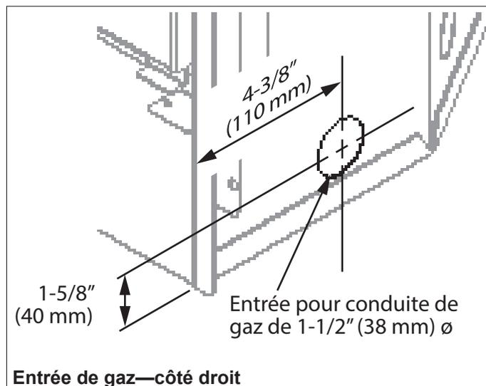
Le raccordement de deux conduites de gaz devrait être fait avec un raccord de métal double étanche ne nécessitant aucun produit ou joint d'étanchéité.
