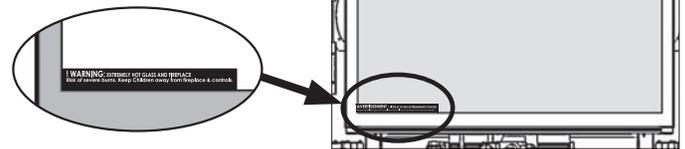
5. Si la plaquette de sécurité a été enlevée du bas de la fenêtre, réinstallez-la en la glissant entre la vitre et le cadre de la fenêtre tel qu'indiqué.
