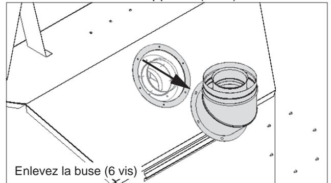
2. Tournez la buse pour que sa sortie soit orientée vers l'arrière et fixez-la de nouveau à l'appareil (6 vis).
