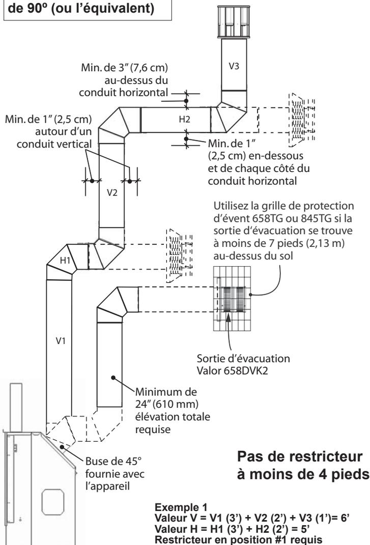
6. Chaque coude de 90° installé horizontalement est équivalent à 3 pi (91 cm) de longueur horizontale; conséquemment, 3 pi (91 cm) doivent être soustraits de la longueur du parcours horizontal permis. (Le coude de 45° est équivalent à un conduit horizontal de 18 po (46 cm).)
