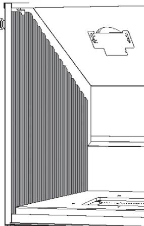
3. Placez le panneau arrière contre la paroi arrière de la boîte de foyer derrière l'onglet de retenue sur la rainure du bas et derrière le panneau de côté déjà installé.
