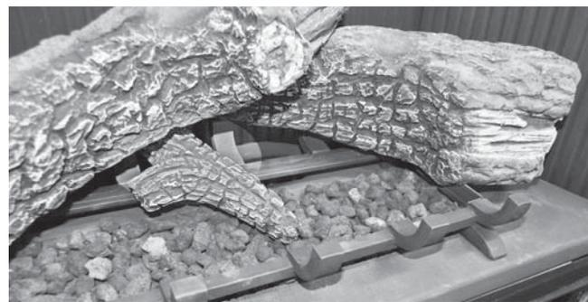
6. Placez la bûche gauche du dessus en posant l'encoche du bout avant sur le montant du porte-bûches entre les première et seconde dents. L'autre bout de la bûche repose sur la bûche arrière gauche tel qu'indiqué.
