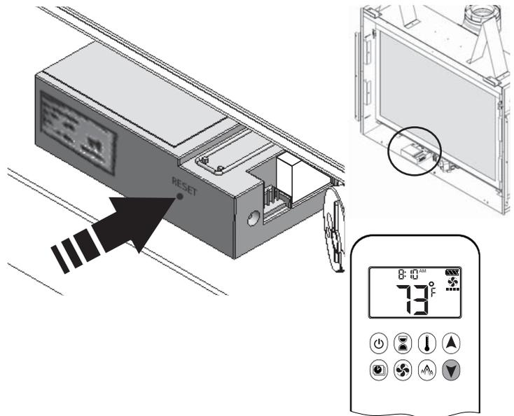
La télécommande est maintenant prête à être utilisée. Cette procédure n'est effectuée qu'une seule fois avant d'utiliser la télécommande. Le jumelage n'est pas affecté par le changement des piles.
