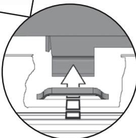
3. Dévissez les écrous de l'obturateur, ajustez-le et resserez les écrous.
