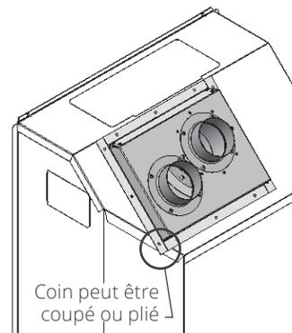
5. Raccordez les conduits flex de 3" directement à leur buse respective et fixez-les avec les colliers de serrage inclus et 2 vis à métaux par conduit.
