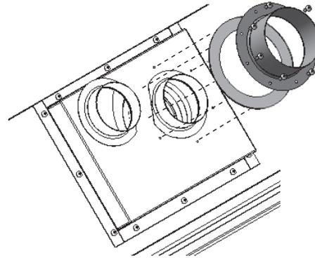
5. Raccordez un conduit flex de 3" à la buse d'entrée d'air et un conduit flex de 4" à la buse d'évacuation et fixez-les avec les colliers de serrage inclus et 2 vis à métaux par conduit. Consultez le guide d'installation du foyer pour compléter le système d'évacuation.
