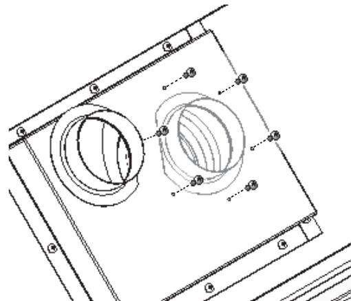
**NOTE :** Sur les modèles 200, un coin du raccord colinéaire dépasse la caisse de l'appareil une fois installé. Ce coin peut être coupé ou plié.
