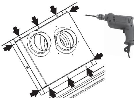
4. Réutilisez les 6 vis enlevées de la buse d'évent pour boucher les trous de vis inutilisés pour la buse de 4 po autour de la buse d'évacuation du raccord. Assurez-vous que les vis soient bien serrées.
