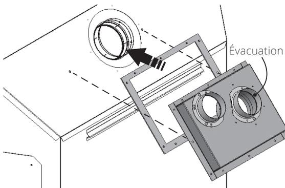
3. Percez les autres trous de fixation à travers les trous du raccord à l'aide d'une perceuse munie d'une mèche de 1/8 po. Fixez le raccord à l'aide de 10 vis à métaux fournies.
