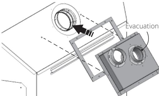
3. Percez les autres trous de fixation à travers les trous du raccord à l'aide d'une perceuse munie d'une mèche de 1/8 po. Fixez le raccord à l'aide de 10 vis à métaux fournies.
