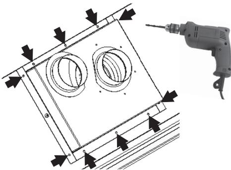
4. Placez le joint d'étanchéité de 4 po et la buse de 4 po sur la buse d'évacuation de 3 po. Fixez la buse à l'aide des 6 vis enlevées du raccord de sortie. Assurez-vous que les vis sont bien serrées.
