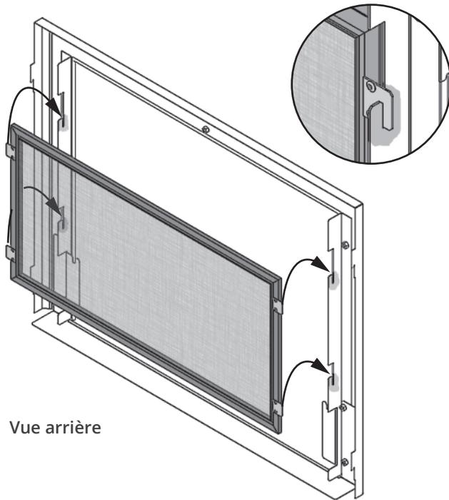
6. **738 seulement.** Accrochez le déflecteur d'extension fourni avec la devanture Clearview à la bordure de métal directement sous le coupe-tirage de l'appareil afin de permettre l'extension de la bordure vers l'avant.
