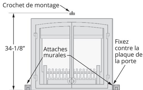
Position du crochet et des attaches
