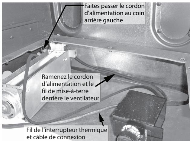
4. Placez le ventilateur à l'arrière de la boîte de foyer (devant ses fils) et fixez-le à la paroi arrière avec les deux vis fournies.
