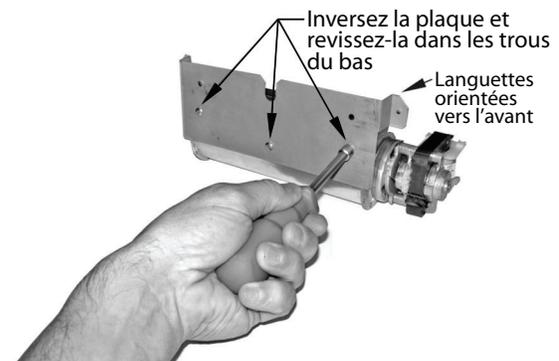
2. Glissez la plaque de montage fixée au ventilateur dans la canalisation de convection de l'arrière de la boîte du foyer.
