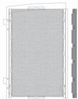
4. Placez le déflecteur sur le support de cadre de porte de façon à ce que les onglets du déflecteur soient tout contre le bord de la grille entre ses crochets.
