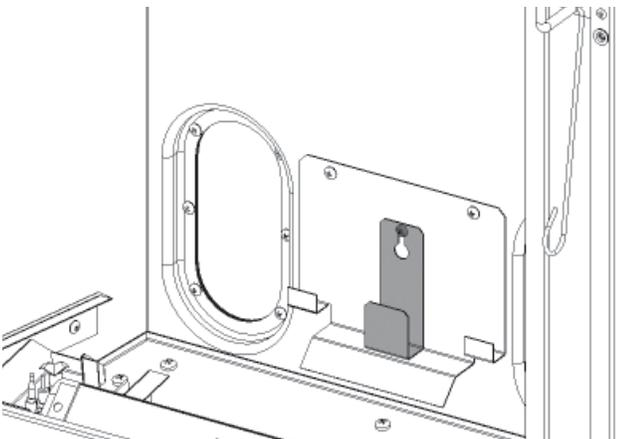
3. Dévissez la vis arrière du montant de panneau de côté. Glissez un support de panneau sur la vis et poussez-le contre le dessous de la bordure sur laquelle doit reposer le panneau. Resserrez la vis.
