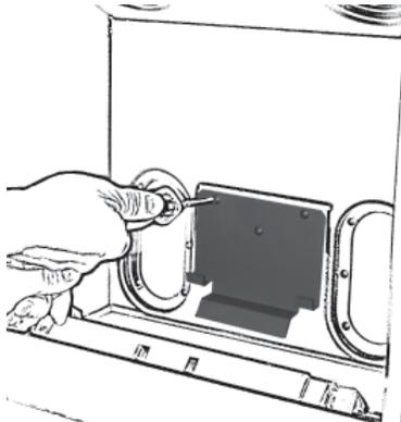
2. Installez le support de panneau arrière pour pierres sur le support de bûche que vous venez d'installer. Glissez le support de panneau sur la vis du milieu et poussez-le vers le bas jusqu'à ce qu'il touche la bordure où doit reposer le panneau arrière. Resserrez la vis.
