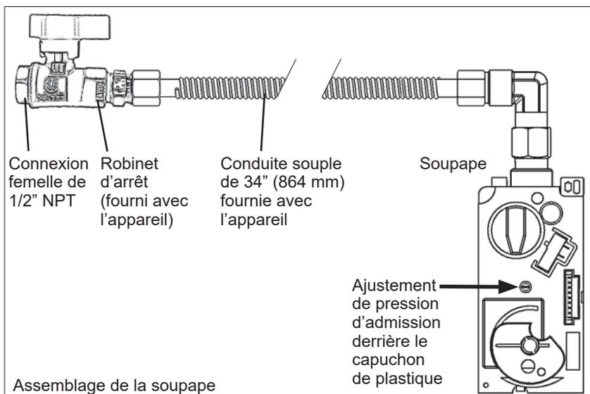
L'appareil doit être isolé du système d'alimentation de gaz en fermant son robinet d'arrêt manuel durant toute vérification de pression de ce système lorsque la pression de vérification est égale ou inférieure à 1/2 lb/po<sup>2</sup> (3,5 kPa).
