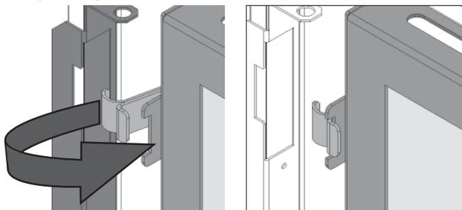
4. Tirez sur le dessus de la fenêtre et relâchez-le afin de vous assurer que le mécanisme à ressort fonctionne bien.
