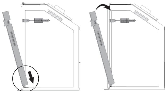
3. En tenant la fenêtre, décrochez les leviers des supports et accrochez-les aux languettes du cadre de la fenêtre de chaque côté tel qu'indiqué.
