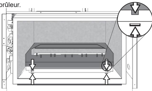
2. Insérez la base de céramique pour les pierres à l'intérieur de la plateforme derrière le brûleur. Assurez-vous que la base repose tout contre les onglets de métal derrière le brûleur.
