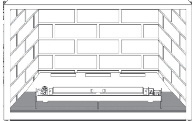
12. **Avec bûches seulement** : Installez le porte-bûche en insérant ses languettes dans les fentes devant le brûleur.
