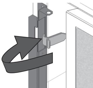
2. Placez la fenêtre sur la rainure du bas et poussez-la contre la boîte de foyer. **Assurez-vous qu'aucune particule ne se trouve dans la rainure avant d'installer la fenêtre.**
