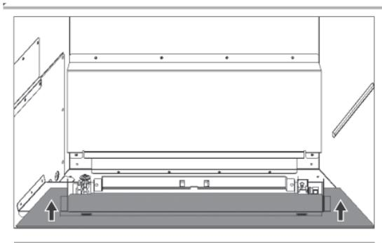
3. À l'intérieur de la boîte de foyer, au haut de chaque côté, dévissez les vis des supports d'ancrage des panneaux juste assez pour leur permettre de pivoter.
