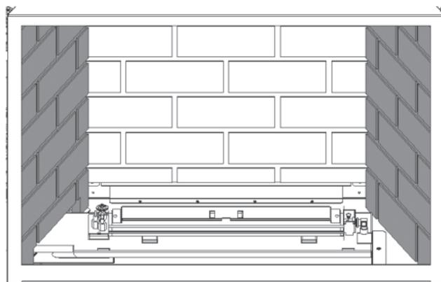
7. Resserrez les vis des supports d'ancrage de chaque côté.
