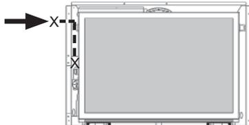
Utilisez seulement de nouvelles conduite de fer noir, d'acier ou de cuivre si acceptable—vérifiez les codes locaux. **Notez qu'aux États-Unis, les conduites de cuivre doivent être étamées aux fins de protection contre les composés sulfuriques.**
