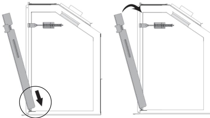
3. En tenant la fenêtre, décrochez les leviers des supports de la bordure et accrochez-les dans les encoches des languettes sur le cadre de la fenêtre tel qu'indiqué.
