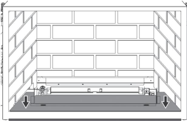
10. Réinstallez le support de bûche arrière (3 vis). Son bord arrière devrait reposer sur la languette retenant le panneau arrière.
