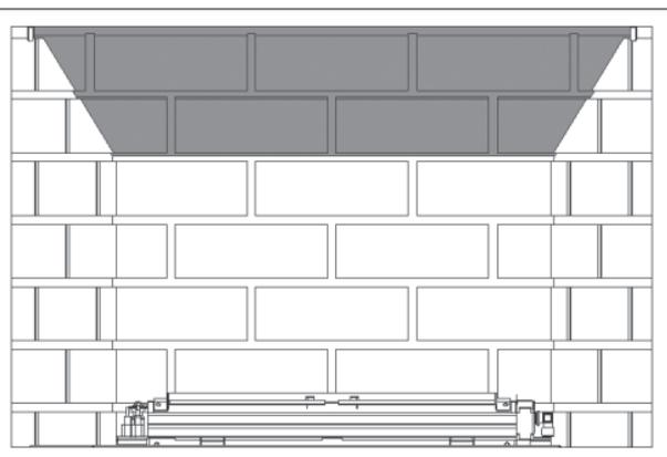
9. Réinstallez le support des briques avant.
