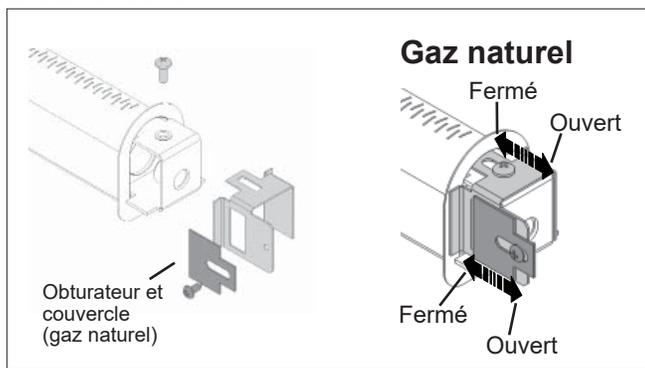
Cependant, dans certains cas inhabituels, l'aspect des flammes peut être amélioré en changeant le réglage de l'aération. La nécessité de réglage devrait être déterminée seulement après avoir fait fonctionner l'appareil avec les bûches et panneaux de céramique et avec la fenêtre installés.
