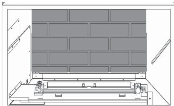
5. Pivotez le support d'ancrage du côté gauche vers le haut et placez le panneau gauche contre la paroi de la boîte de foyer. Pivotez le support vers le bas sur le panneau pour le maintenir en place.
