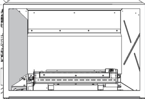
2. Placez le panneau de verre gauche, côté lisse visible, contre le panneau de remplissage. Pivotez le support d'ancrage sur les deux panneaux pour les maintenir en place.
