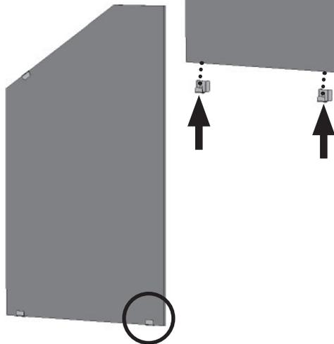
9. Pivotez le support d'ancrage vers le haut et insérez le panneau droit contre la paroi de la boîte de foyer. Pivotez le support d'ancrage vers le bas pour maintenir le panneau en place.
