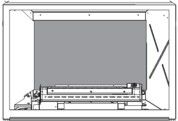
5. Placez le panneau du haut sur le dessus des panneaux gauches et arrière.
