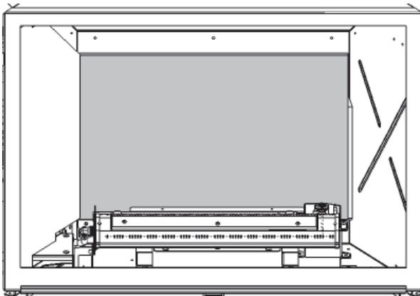
4. Placez le panneau de verre arrière, côté lisse visible, contre le panneau de remplissage. Glissez les deux panneaux derrière les panneaux gauches.
