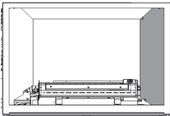
10. Serrez les vis des supports d'ancrage des deux côtés de la boîte de foyer.
