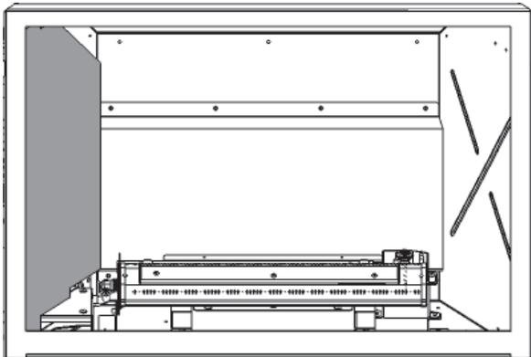
3. Placez le panneau de remplissage arrière sur la rainure contre la paroi arrière de la boîte de foyer.
