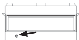
Soupape accessible à travers le trou dans la paroi avant du foyer
