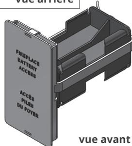
13. Branchez le connecteur à boutons-pression, insérez 4 piles **alcalines** AA dans le porte-piles (fournies avec le foyer) et insérez le porte-piles à l'intérieur de la boîte de raccordement. Le couvercle du compartiment à piles s'attache à la boîte avec les aimants. **NE METTEZ PAS de piles dans le récepteur, seulement dans le porte-piles à côté de l'interrupteur mural.**
