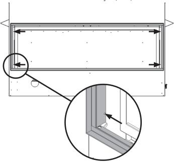
Les matériaux de finition du mur peuvent être maintenant appliqués. Le panneau de béton, la tuile ou autre fini peuvent être aboutés au cadre. Ne pas empiéter sur l'ouverture afin de pouvoir installer le pare-étincelles.
