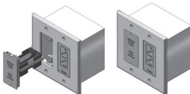
Note : Ne placez pas de piles dans le récepteur, seulement dans le porte-piles à côté de l'interrupteur mural.
