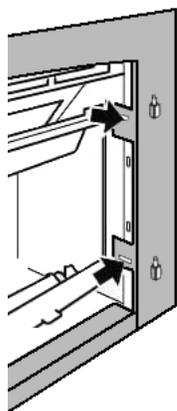
4. Accrochez les supports de côtés droit et gauche. Ajustez les languettes de l'encadrement du foyer en les pliant si nécessaire.
